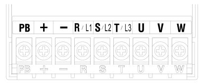
a) Schematic Diagram of Terminals (EM730-0R7-3B~EM730-1R5-3B)
