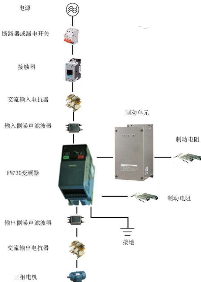
图 3- 1 变频器与外围设备的连接图
